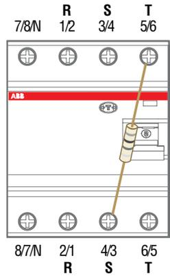
Для использования в трехфазной цепи без нейтрали при 400 В можно подключить три фазы R, S и T, как на рисунке.
