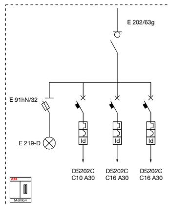
Устройства, показанные на схеме внутри пунктирной линии, доступны только в версии Premium
