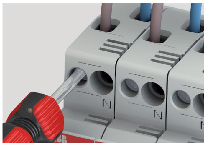
Затяжка винтов Prozidriv PZ2 может быть выполнена путем приложения меньшего момента затяжки по сравнению с обычными винтами, при этом одна и та же электрическая отвертка могут быть использована для всех клемм.
