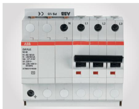
Рычаг модульного автоматического выключателя указывает на состояние устройств серии OVR Plus. Если рычаг взведен, защита от перенапряжения активна. Если рычаг выключен и может быть взведен, то устройство защищает оборудование. Если рычаг выключен и не взводится, устройство необходимо заменить.
