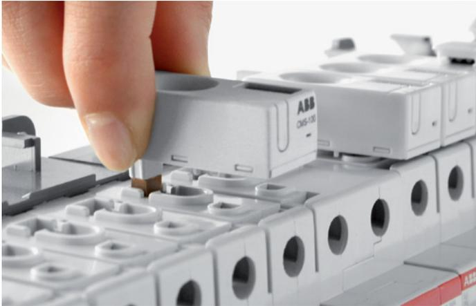
CMS представляет собой многоканальную систему измерения токов для мониторинга линий переменного и постоянного тока до 160 А. Различные типы датчиков допускают монтаж в любой среде установки. Измерение токов внутри блоков распределения питания (БРП) очень близко к электрическим нагрузкам повышает эффективность и доступность каждой установки.
