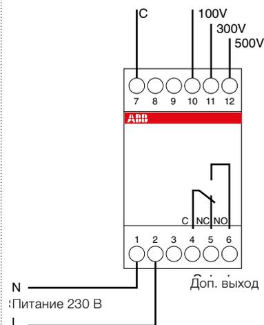
Схема подключения ISOLTESTER-DIG, QSD-DIG и SELVTESTER-24 для трансформатора с центральной точкой (PC)
