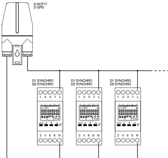
Антенна DCF77 позволяет синхронизировать время до 10 шт реле. Полярность подключения первого устройства неважна, для последующих устройств должна соблюдаться полярность подключения первого устройства.
