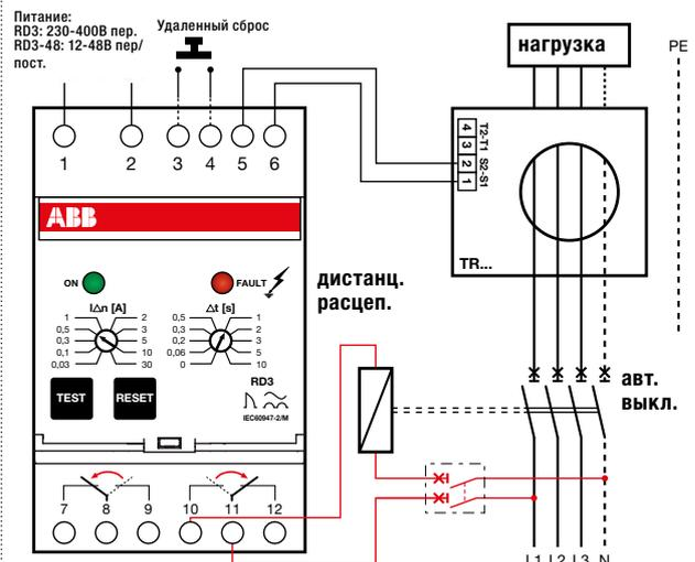
\* защита от токов утечки неактивна когда авт. выключатель выключен
