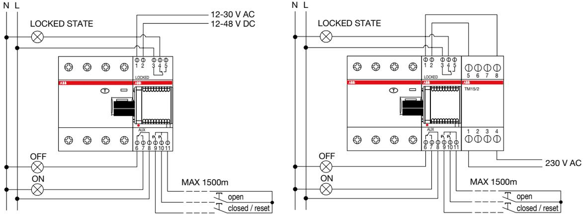
Схема питания нескольких моторных приводов или устройств автоматического включения : 12..30В перем., 12-48В пост. тока
