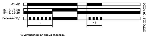
$t$  = установленная время задержки
