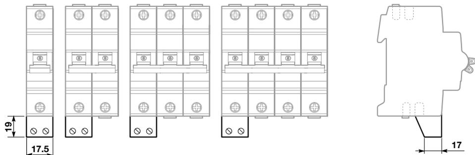
S 2C-EST Устройство для втычного монтажа
