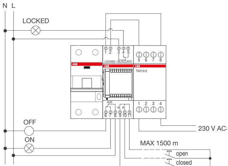
Схемы подключения моторного привода F2C-СМ и устройства автоматического включения F2C-ARI
