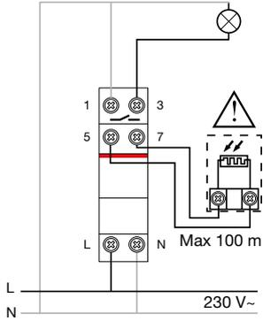
T1 POLE Реле освещенности для монтажа на опору
