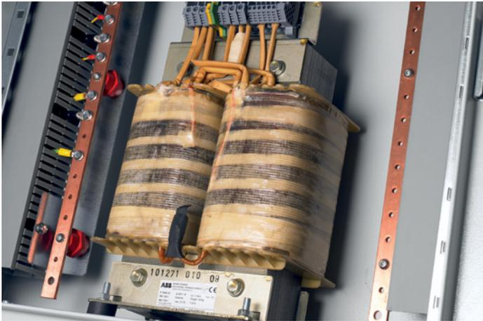
Специально разработанные и собранные для медицинских целей согласно IEC EN 61558-2-15, они обеспечивают защиту от не прямых контактов без необходимости автоматически разрывать цепь при первом замыкании на землю.
