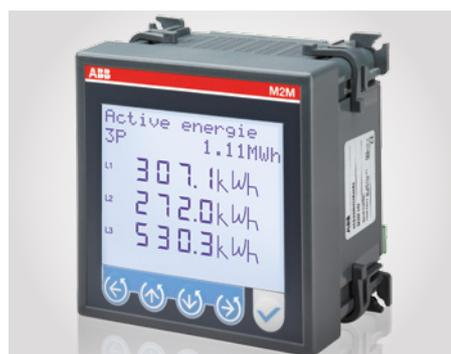
Всю информацию, собранную анализатором M2M, можно быстро передать на удаленное расстояние с помощью специальных интерфейсов связи — RS485, RJ45 — при поддержке многочисленных протоколов, включая Modbus RTU, Modbus TCP/IP и Profibus DP. Взаимодействие с системами управления и наблюдения возможно с помощью различных программируемых цифровых входов и цифровых, релейных или аналоговых выходов.
