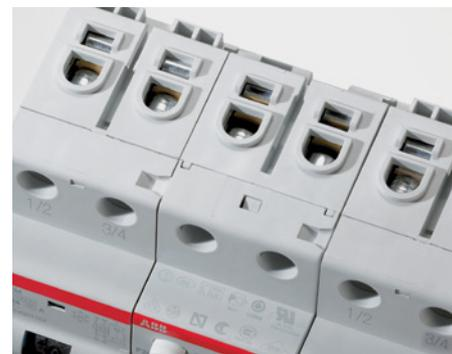
Разъемы, имеющиеся на DS201 — DS202C, облегчают подачу питания параллельно с шинами, поскольку они состоят из двух различных гнезд: переднее гнездо для кабелей 25 мм<sup>2</sup> и заднее гнездо для шин 10 мм<sup>2</sup>.
