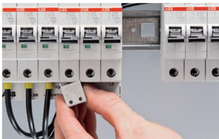
Модульные автоматические выключатели могут быть дополнены вспомогательным контактом (1 НО и 1 НЗ), монтирующимся снизу. Тем самым, можно легко модернизировать существующие электроустановки для обеспечения вспомогательных функций.
