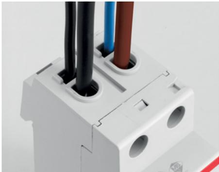
Доступны два клеммных разъема: передний для кабелей до 25 мм<sup>2</sup>, задний для кабелей до 10 мм<sup>2</sup> или для шин.
