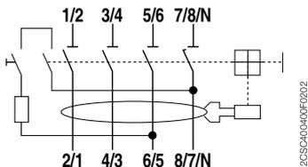
В случае установки аппарата в трехфазной цепи без нейтрали, если напряжение цепи составляет от 110 до 254 В (277 В согласно UL 1053), для корректной работы кнопки тестирования есть два возможных решения:
