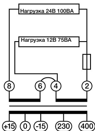
Плавкий предохранитель следует выбирать в соответствии с большим значением напряжения нагрузки и размещать в точке прохождения токов обеих нагрузок.
