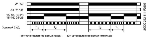
с контактора "звезда" на контактор "треугольник"  $t_2$ . По окончании времени переключения  $t_2$  второй переключающий контакт активирует контактор "треугольник", подключенный к клеммам **17-28**. Контактор "треугольник" остается под напряжением все время, пока на прибор подается напряжение питания.
