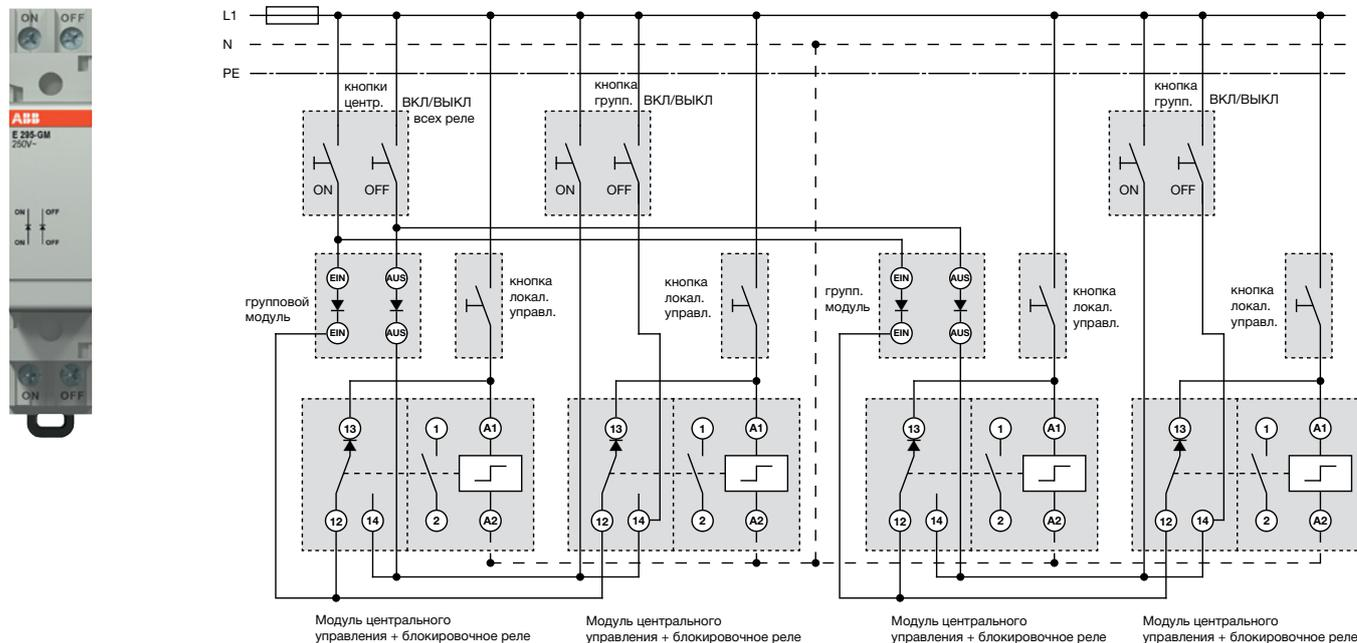
Пример центрального управления реле E290 при использовании с модулем E293/X, объединенным с групповым модулем E295-GM; С помощью локальных кнопок можно управлять каждым блокировочным реле. Используя групповые модули, можно разделить различные группы освещения. При нажатии на кнопку „групповое ВКЛ/ВЫКЛ“ можно индивидуально управлять каждой группой. Общая кнопка „Центральное ВКЛ/ВЫКЛ“ переводит все реле E290 в то или иное положение (ВКЛ/ВЫКЛ).
