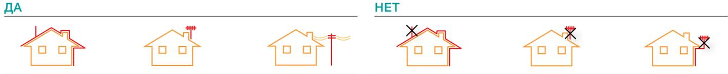
Присутствует внешняя система молниезащиты (или в общем случае с заземленными периферийными проводящими частями) или высокие точки
