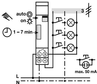
E 232-230 3-проводная схема
