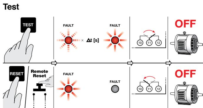
В версии RD3P также можно выполнить тестирование без отключения путем одновременного нажатия кнопки тест на передней панели и кнопки сброса в течение 3 секунд. В этом случае выходные контакты не будут переключаться, как показано на рисунке ниже:
