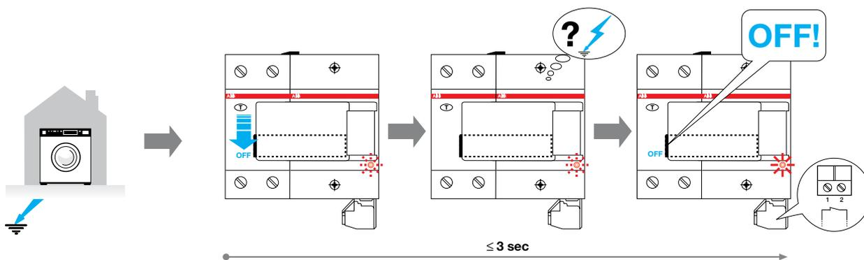
Ситуация постоянного замыкания на землю, что вызывает срабатывание ВДТ.
