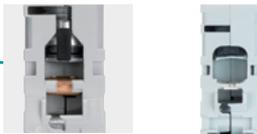
Усовершенствованные клеммы для подключения кабелей до 35мм<sup>2</sup> (на ном. ток до 63А) и до 50 мм<sup>2</sup> (на ном. ток 80,100А). Для проводников с наконечниками или без них. Соответствуют требованиям степени защиты IP20 (защита от прикосновения пальцем) согласно IEC/EN 60529. Встроенная пластина, защищающая гибкие кабели от повреждения и однородного давления на открытую клемму.
