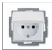
Механизм розетки SCHUKO® с крышкой с безвинтовыми клеммами 2 P + E с откидной крышкой (фиксируется в открытом положении) Номинальное напряжение: 250 В перем. тока Номинальный ток: 16 А
